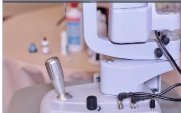
Vue latérale de la lampe à fente du BEOC montrant l'emplacement du bouton de réglage de l'intensité
