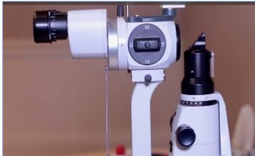
Vue latérale de la lampe à fente du BEOC montrant l'emplacement du bouton de réglage du grossissement
